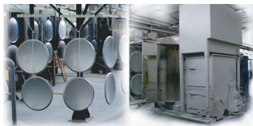
Ligne de peinture intégrée et traitement de la surface du disque
